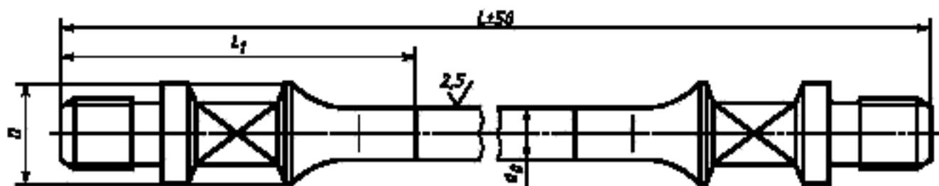
*б — металлическая штанга с приваренными головками (ШНП)*
