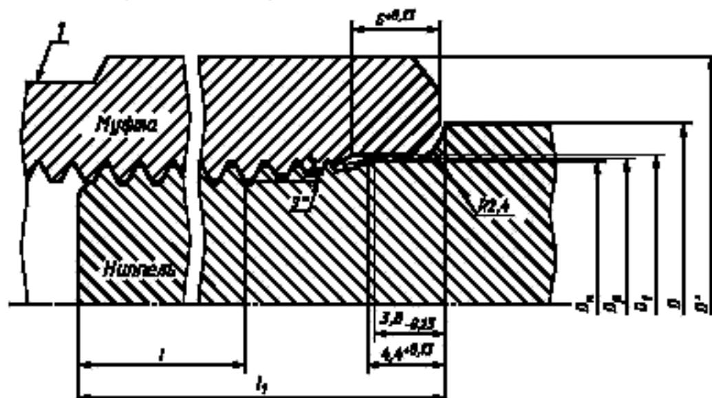
1 — поверхность под ключ;  $D_n$  — диаметр поиска ниппеля,  $D_p$  — диаметр расчетный теоретический;  $D_1$  — диаметр выточки муфты;  $D$  — наружный диаметр устьевого штока;  $D'$  — наружный диаметр муфты;  $l$  — длина цилиндрической части резьбы ниппеля,  $l_1$  — длина ниппеля
