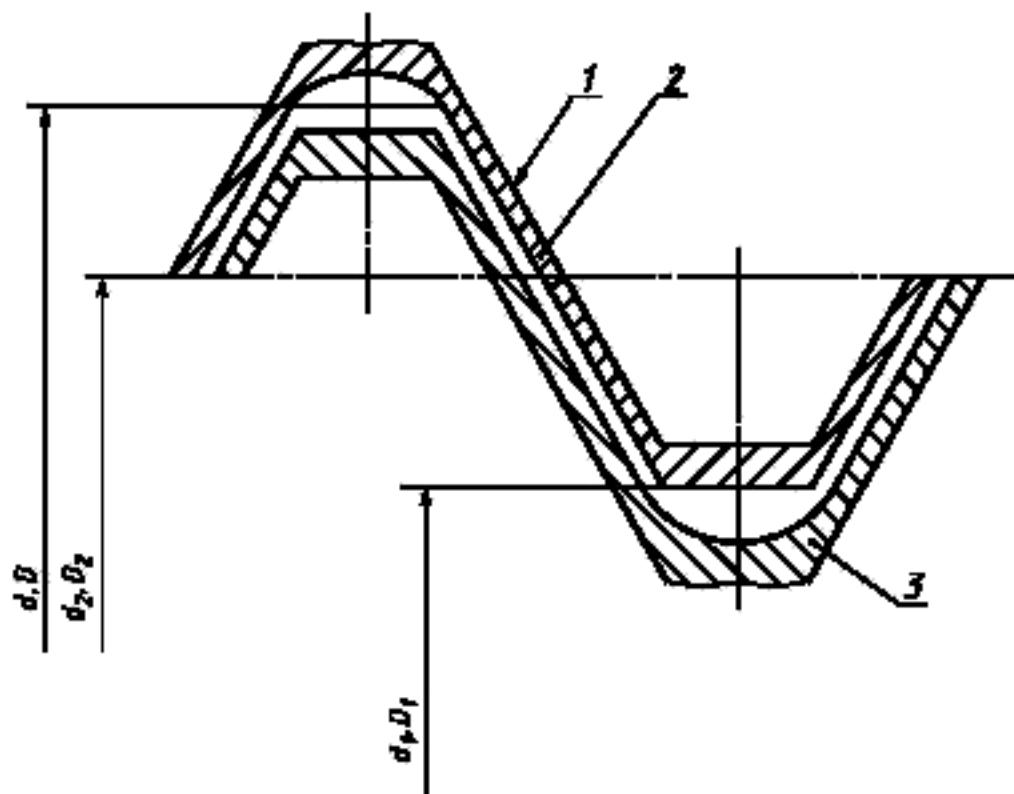
1 —名义ный профиль резьбы; 2 — поле допуска внутренней резьбы; 3 — поле допуска наружной резьбы
