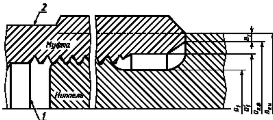
1 — плоскость конца резьбы муфты (продолжение резьбы муфты по выбору изготовителя);
