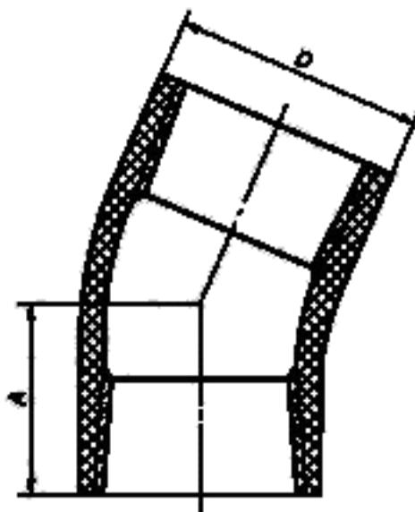
*A* — длина оси присоединительной части отвода; *D* — наружный диаметр
