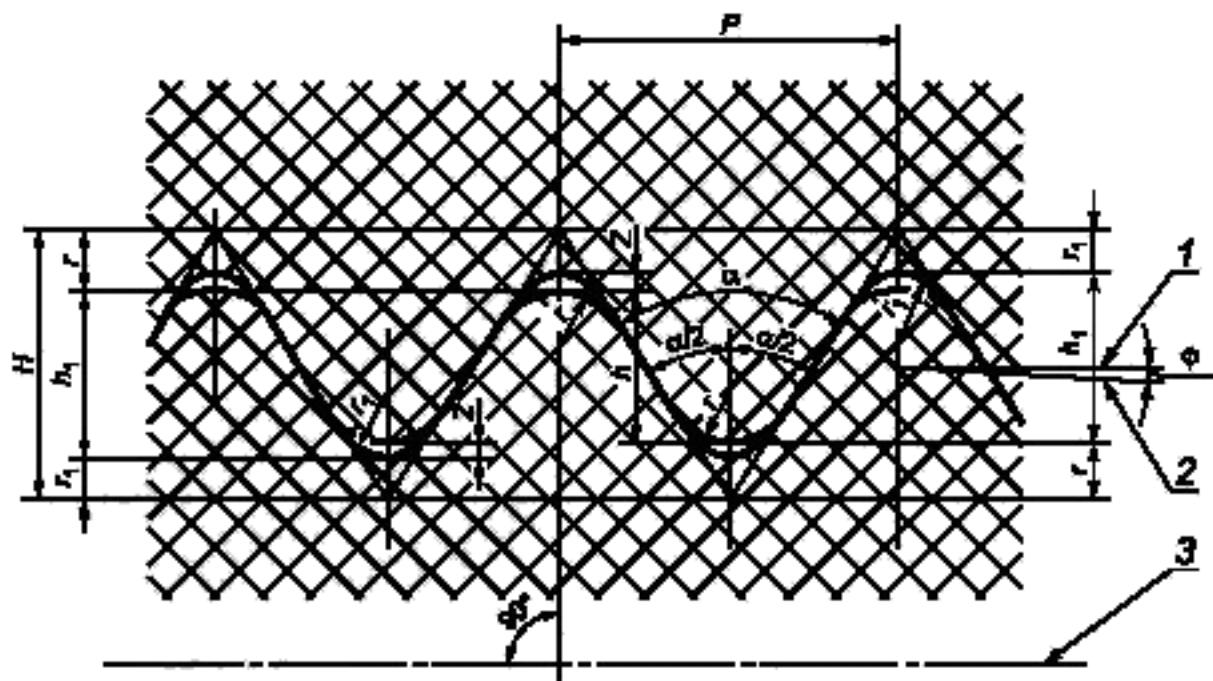
1 — линия, параллельная оси резьбы; 2 — линия среднего диаметра резьбы; 3 — ось резьбы;  $P$  — шаг резьбы (измеряется параллельно оси резьбы);  $H$  — высота исходного профиля;  $h_1$  — высота профиля;  $h$  — рабочая высота профиля;  $\alpha$  — угол профиля;  $Z$  — зазор;  $\phi$  — угол наклона,  $r$ ,  $r_1$  — радиус закругления
