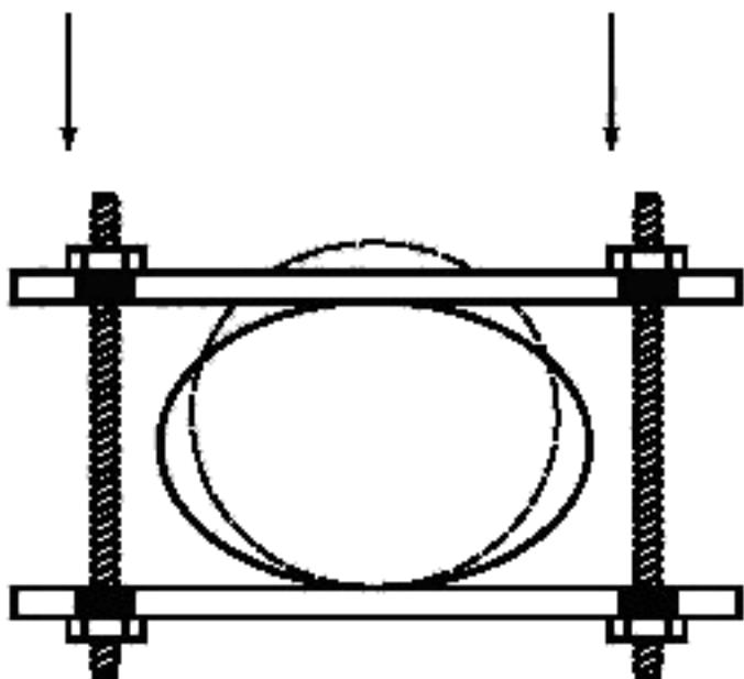
Рисунок 13 — Схема приложения нагрузки
