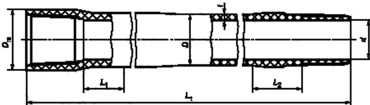
$L_1$  — длина трубы;  $D$  — наружный диаметр трубы;  $D_r$  — диаметр раструба,  $d$  — внутренний диаметр,  $t$  — толщина стенки трубы;
