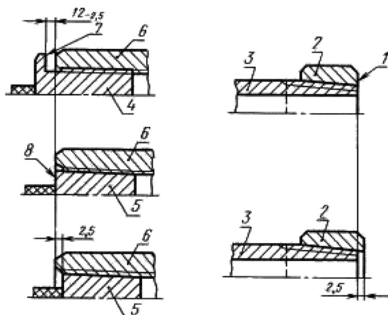
1 — измерительная плоскость резьбового и гладкого калиброн-
