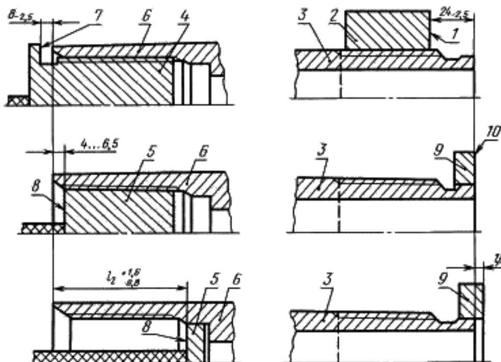
1 — измерительная плоскость резьбового и гладкого калибр-колец; 2 — резьбовой и гладкий калибр-кольца; 3 — труба ОТТГ и ниппельный конец трубы ТБО; 4 — резьбовой калибр-пробка; 5 — гладкий калибр-пробка; 6 — муфта ОТТГ и расструбный конец трубы ТБО; 7 — измерительная плоскость резьбового калибра-пробки; 8 — измерительная плоскость гладкого калибра-пробки; 9 — гладкий калибр-кольцо; 10 — измерительная плоскость гладкого калибра-кольца
