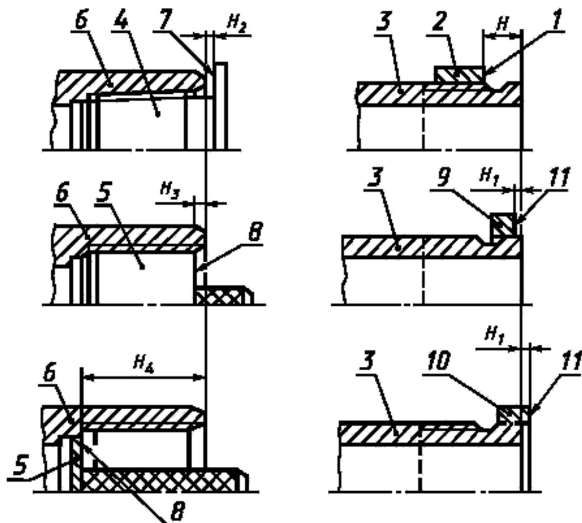
1 — измерительная плоскость резьбового и гладкого калибров-колец; 2 — резьбовой и гладкий калибры-кольца; 3 — труба; 4 — резьбовой калибр-пробка; 5 — гладкий калибр-пробка; 6 — муфта; 7 — измерительная плоскость резьбового калибра-пробки; 8 — измерительная плоскость гладкого калибра-пробки; 9 — гладкий калибр-кольцо для проверки труб условным диаметром от 60 до 102 мм; 10 — гладкий калибр-кольцо для проверки труб условным диаметром 114 мм; 11 — измерительная плоскость гладкого калибра-кольца
