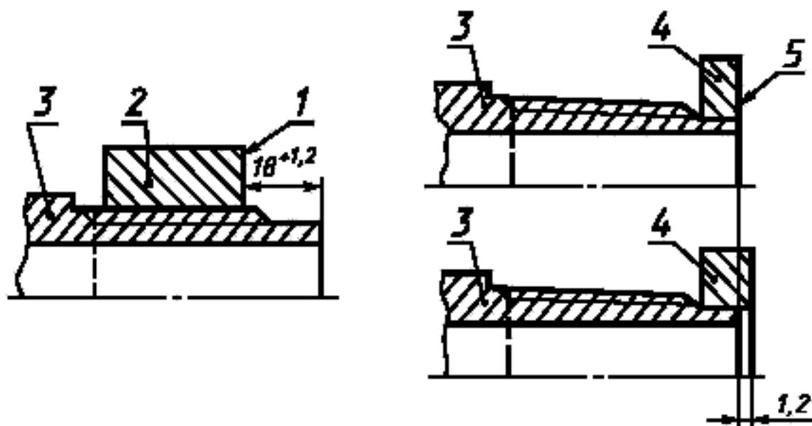
1 — измерительная плоскость резьбовых (с полным и неполным профилем) и гладкого калибров-колец; 2 — резьбовой (с полным и неполным профилем) и гладкий калибры-кольца; 3 — ниппельный конец трубы; 4 — гладкий калибр-кольцо; 5 — измерительная плоскость гладкого калибра-кольца
