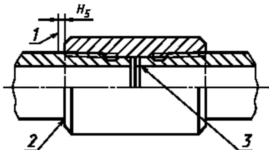
1 — конец сбега резьбы; 2 — соединение, сваренное вручную; 3 — соединение, сваренное на станке
