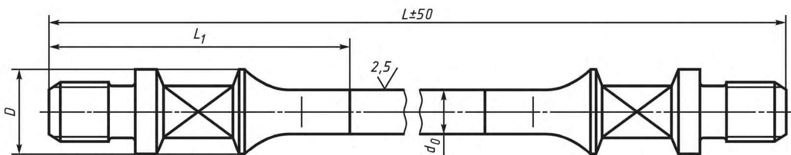
б — металлическая штанга с приваренными головками (ШНП)
