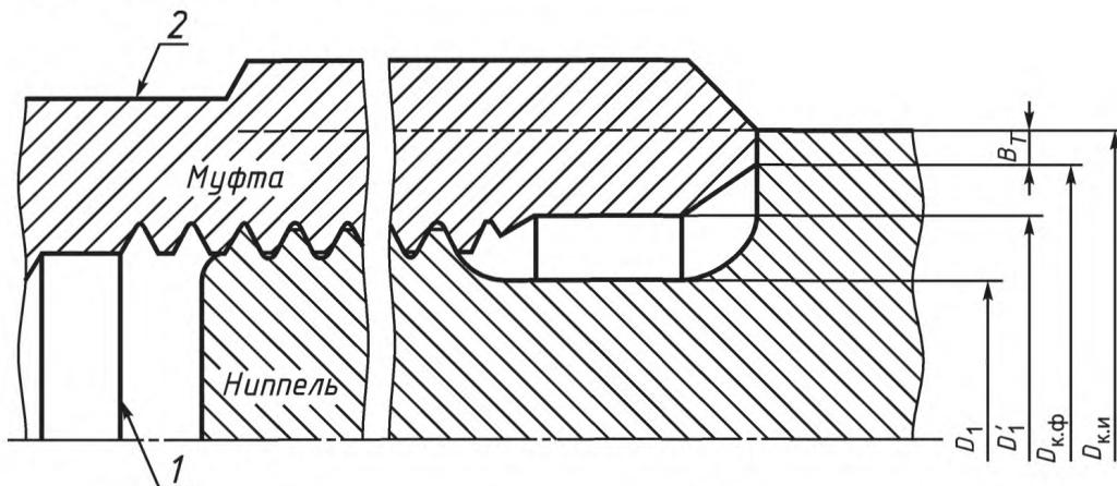
1 — плоскость конца резьбы муфты (продолжение резьбы муфты по выбору изготовителя);
