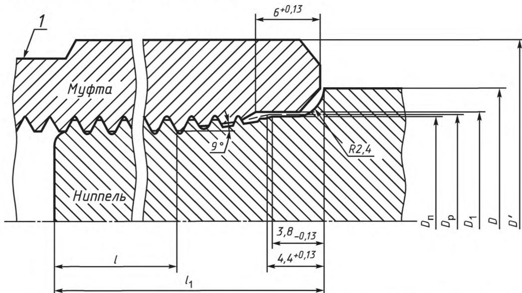
1 — поверхность под ключ;  $D_n$  — диаметр пояска ниппеля;  $D_p$  — диаметр расчетный теоретический;  $D_1$  — диаметр выточки муфты;  $D$  — наружный диаметр устьевого штока;  $D'$  — наружный диаметр муфты;  $l$  — длина цилиндрической части резьбы ниппеля;  $l_1$  — длина ниппеля
