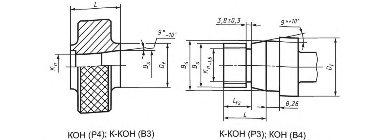
Рисунок Д.4 — Основные размеры калибров КОН (Р4) и К-КОН (Р3) для контроля конуса ниппеля устьевых штоков и калибров КОН (В4) и К-КОН для контроля конуса муфт для устьевых штоков
