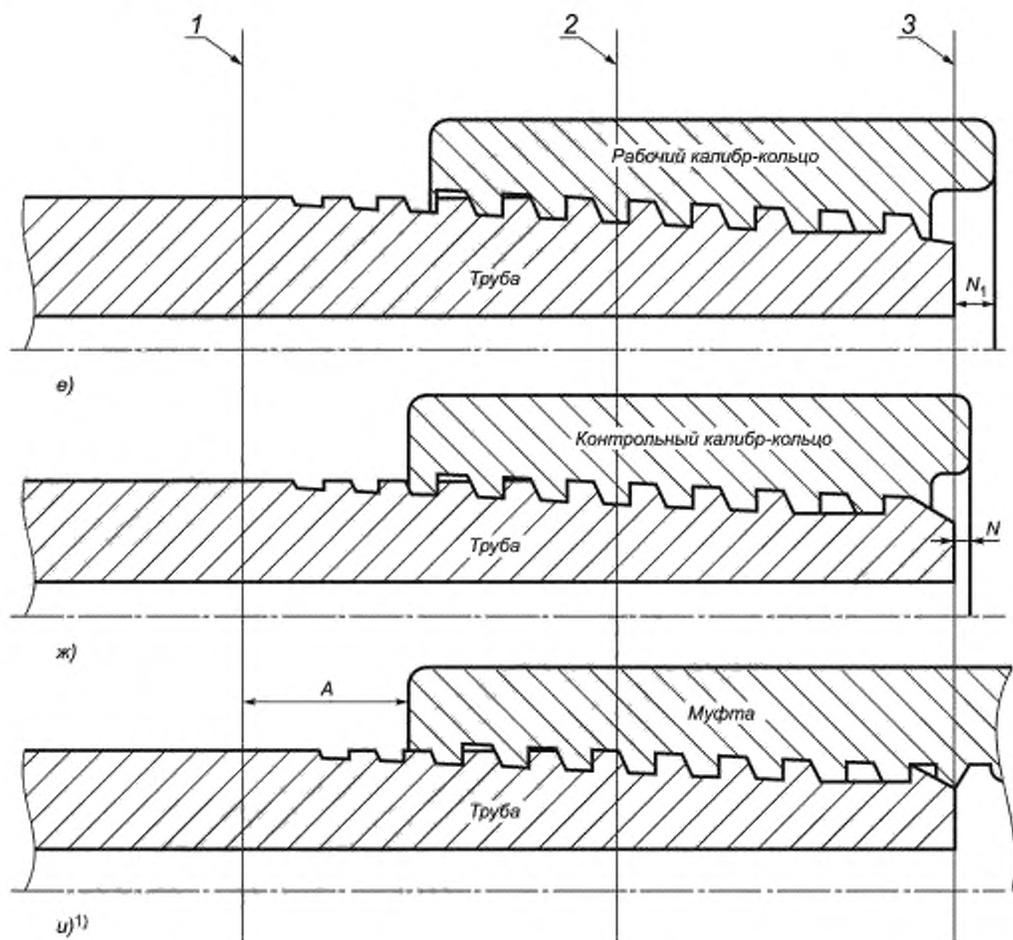
1) Соединение трубы и муфты с номинальными геометрическими параметрами резьбы, свинченное вручную.
