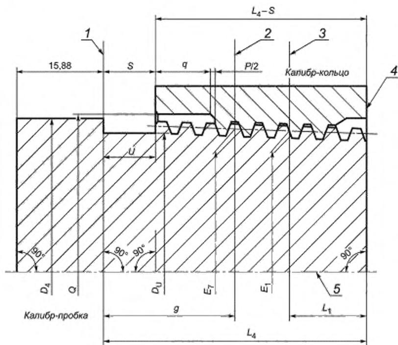
1 — измерительная плоскость; 2 — основная плоскость; 3 — плоскость ручного свинчивания;
