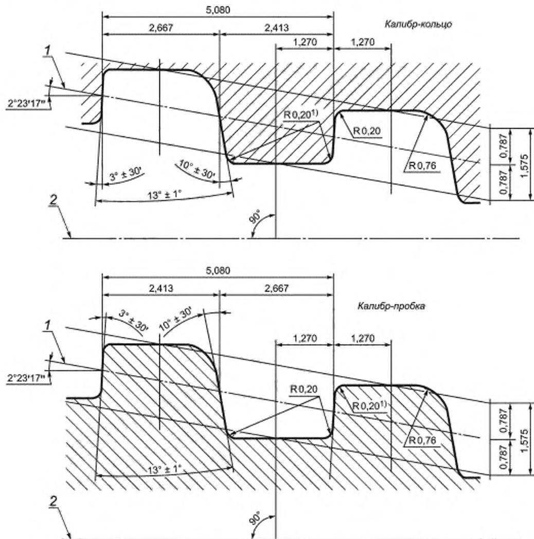
1) Допускается выполнение фаски с углом  $60^\circ \pm 1^\circ$  и шириной  $(0,20 \pm 0,05)$  мм.
