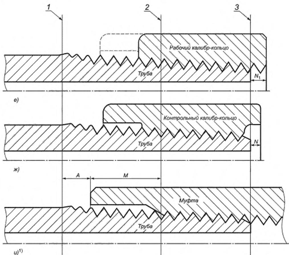
1) Соединение трубы и муфты с номинальными геометрическими параметрами резьбы, свинченное вручную.
