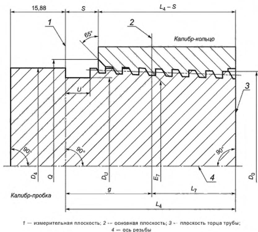
Рисунок 15 — Калибры для контроля резьбового соединения BS
