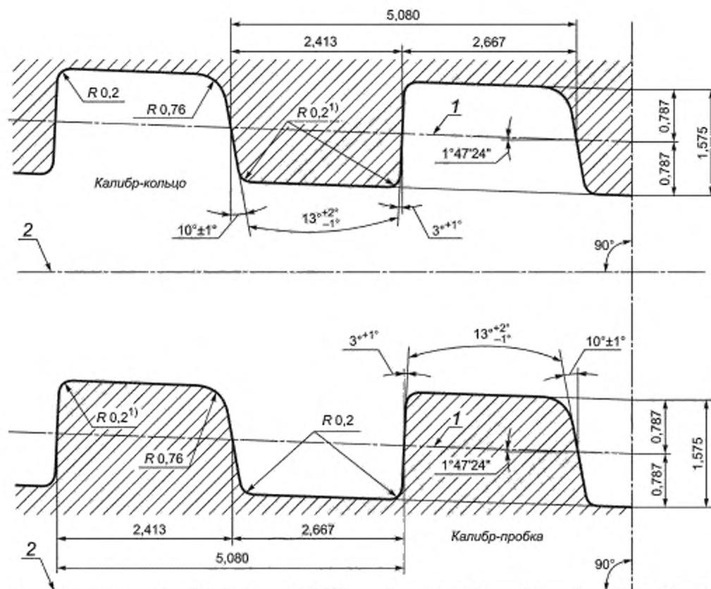
1) Допускается выполнение фаски с углом  $60^\circ \pm 1'$  и шириной  $(0,20 + 0,05)$  мм.
