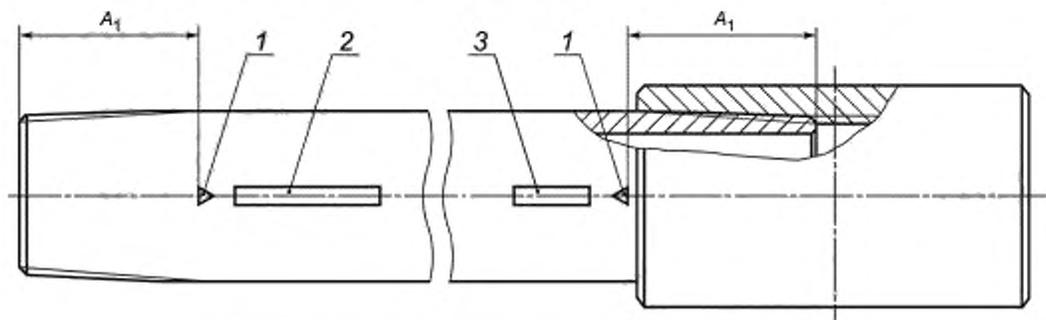
1 — треугольное клеймо; 2 — полоса размером 25 × 610 мм на nipple-конец трубы; 3 — полоса размером 25 × 102 мм на муфтовом конце трубы.  $A_1$  — расстояние от торца трубы до основания треугольного клейма
