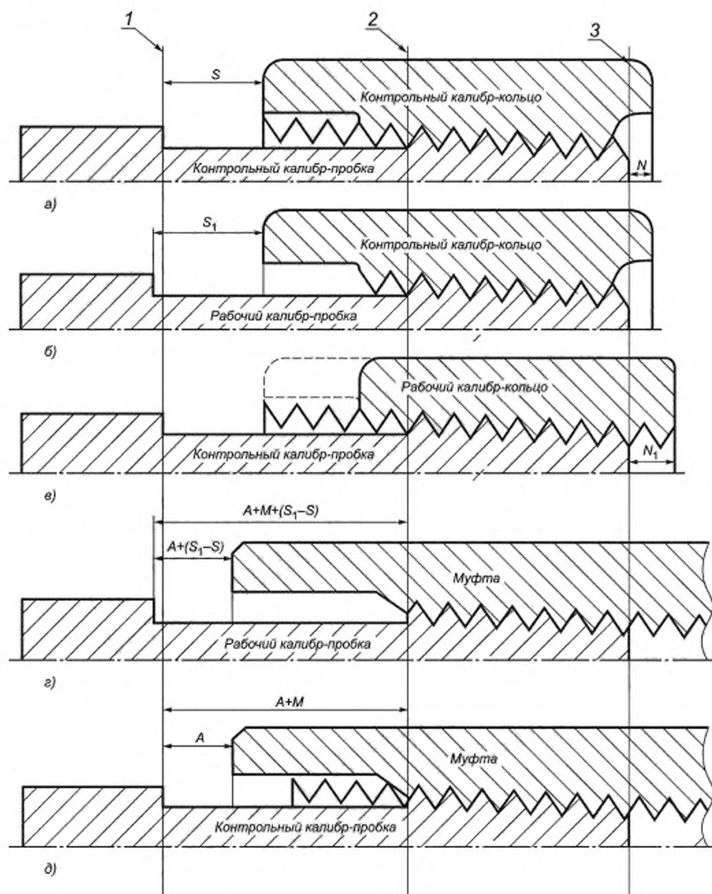
Рисунок 9 — Схема взаимосвязи между контрольными калибрами, рабочими калибрами и резьбой изделий с резьбовыми соединениями LP, SC, LC, NU и EU
