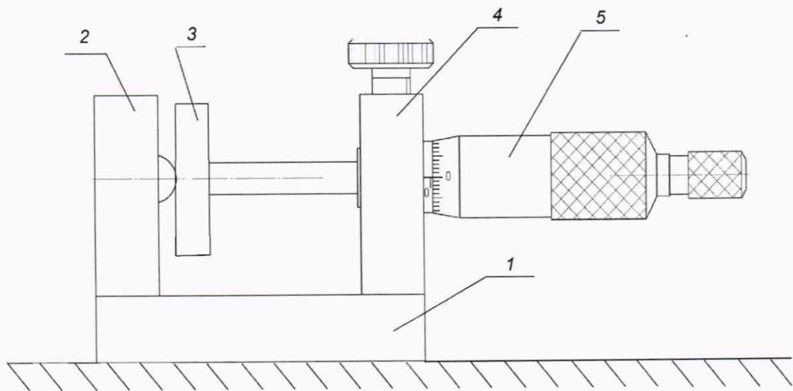
1 - основание; 2 –ложная пятка; 3 – блок концевых мер длины; 4 –крепление микрометра; 5 – проверяемый микрометр
