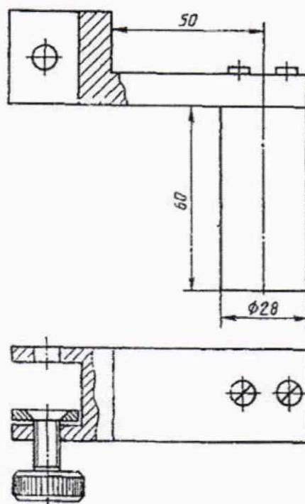
**СХЕМА ОПРЕДЕЛЕНИЯ ИЗМЕРИТЕЛЬНОГО УСИЛИЯ МИКРОМЕТРА**
