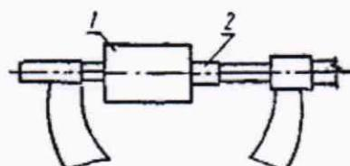
1 - концевая мера длины; 2 - динамометр
