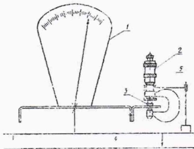
1 - циферблочные весы; 2 - микрометр; 3 - вставка с плоской или цилиндрической поверхностью; 4 - стол; 5 - устройство для крепления микрометра
