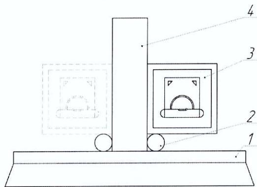
1 - поверочная плита; 2 - металлический опорный валик (требования к диаметру и точности обработки поверхности не предъявляются); 3 - поверяемый уровень;
