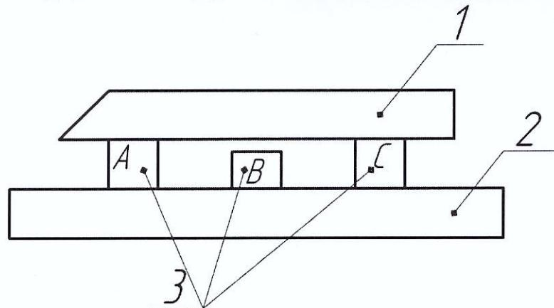
1 – лекальная линейка типа ЛД, ЛТ или ЛЧ класса точности 0 по ГОСТ 8026-92; 2 – плоская стеклянная пластина с отклонением от плоскостности не более 0,03 мкм; 3 – плоскопараллельные концевые меры длины класса точности 2 по ГОСТ 9038-90
