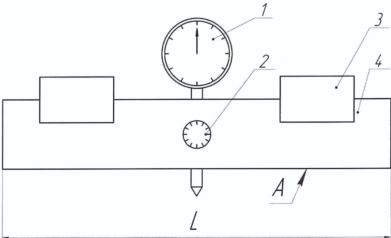
1 – индикатор 1 МИГ по ГОСТ 9696-82; 2 – зажимной винт; 3 – теплоизоляционные ручки; 4 – брускок.
