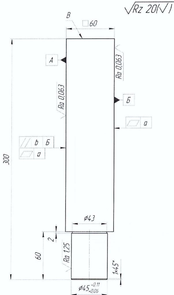
Материал - сталь Х по ГОСТ 5950-2000, допускается замена на сталь ХГ по ГОСТ 14959-79. Твердость 55,8-63,9 HRC.
