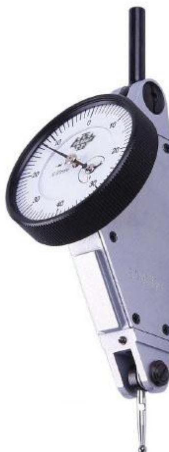
Рисунок 8 – Общий вид индикаторов типа ИРБУ
