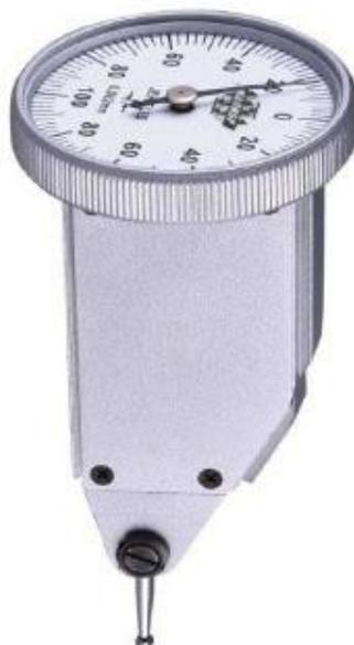
Рисунок 4 – Общий вид индикаторов типа ИРТ
