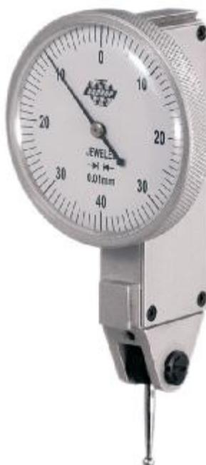
Рисунок 2 – Общий вид индикаторов типа ИРБ
