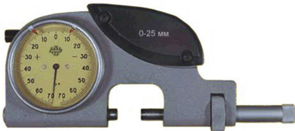
Рисунок 14 – Общий вид скоб модели СРП
