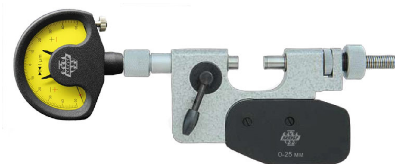
Рисунок 3 – Общий вид скоб модели СИ
