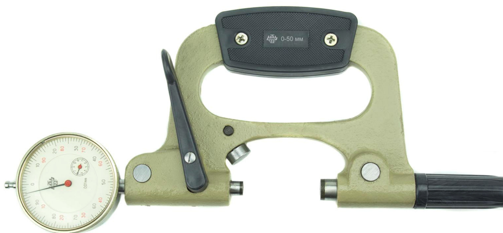
Рисунок 1 – Общий вид скоб модели СИ
