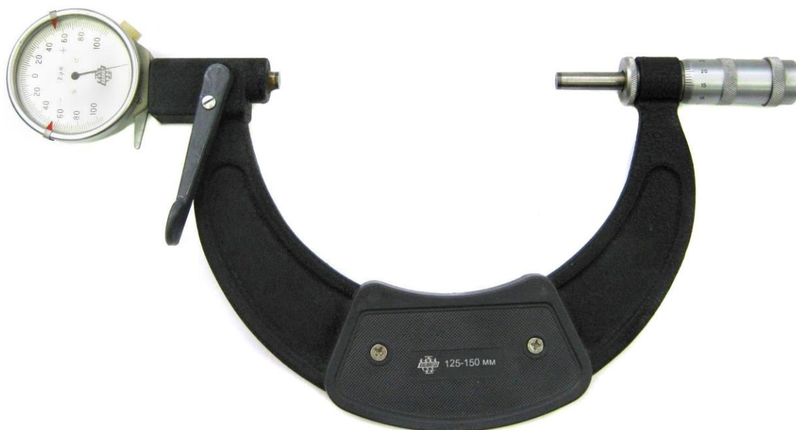
Рисунок 18 – Общий вид микрометров модели МРИг
