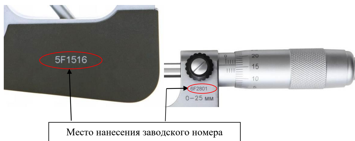
Рисунок 30 – Места нанесения заводского номера
