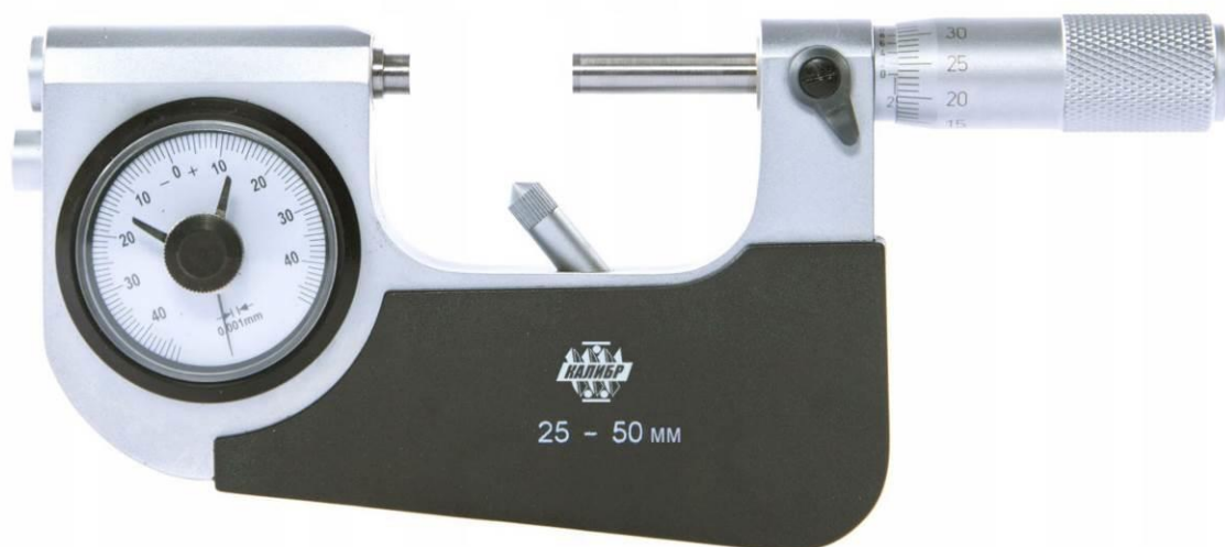
Рисунок 2 – Общий вид микрометров модели МР
