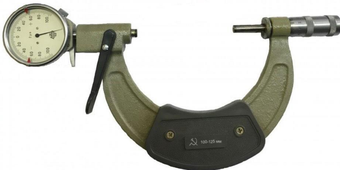
Рисунок 17 – Общий вид микрометров модели МРИг
