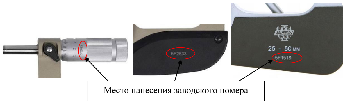
Рисунок 29 – Места нанесения заводского номера
